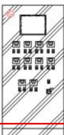
MCS-ITC キャビネット 8-10ステーションを制御するためのアラーム機能を備える
