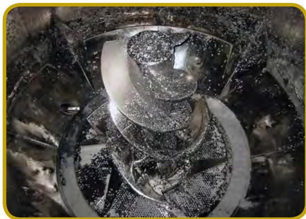
上の写真の300 mmハイコンパルパーのインテリア
