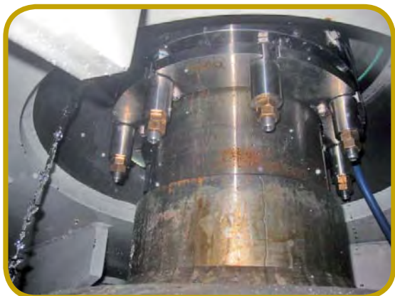
OCC処理中のパルパーに付いた 280 mmシャフトの分割型EP TYPE-1
