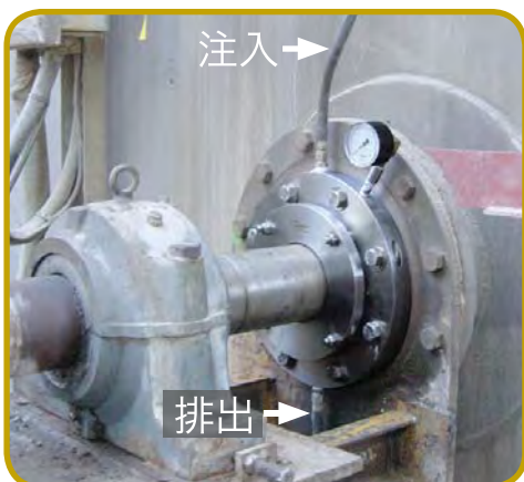
黒液攪拌機に取り付けた4.5”の完全分割型EA TYPE-1シール
