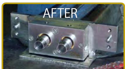
プラスチック添加剤を密封する2軸スクルーフィーダーの1.22"(31 mm)シャフトに取り付けたMECO AH TYPE-2Sシール
