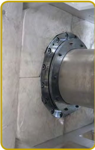
12.4" (315 mm)シャフトの付いた ポリマードライヤーのEA TYPE-2S
