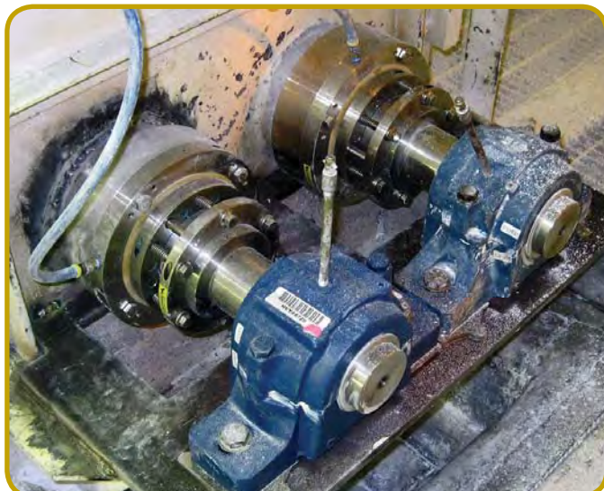
微粒子鉱物を処理する水平パドルミキサーに取り付けた2つの5"分割型OFS TYPE-1シール
