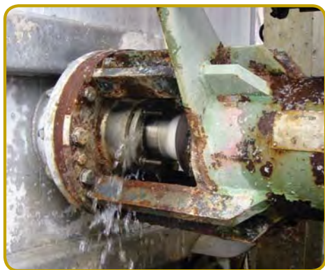
BEFORE: 4"の紙料攪拌機に取り付けられた スタッフィングボックス
