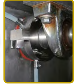
図1 クリーム製造機に取り付けられたMECO AH TYPE-2の乳製品シール
