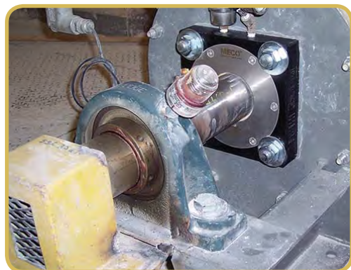
平行の石膏フィーダーに取り付けた3"のHBZ4W4A300シール
