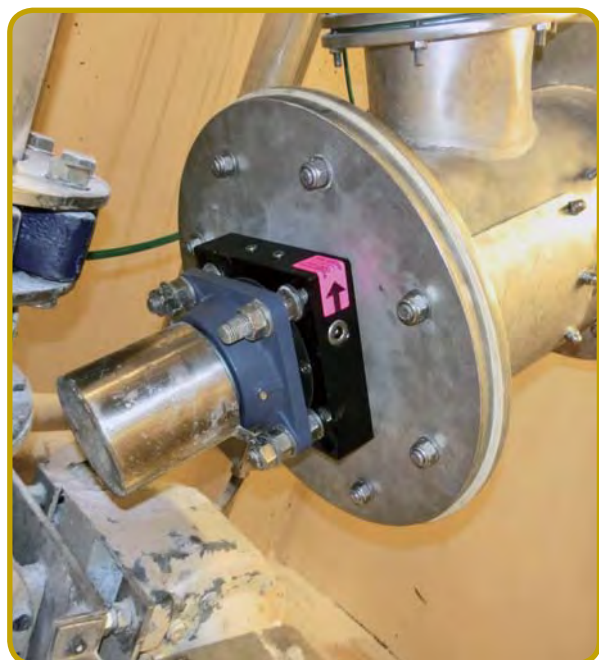
傾斜したスクリーコンベアの40 mmシャフトに 取り付けたHCZ1W4A157シール
