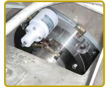
図2 ATEX EN 94/9の防爆指令に準拠したMECO AH TYPE-2Sシール
