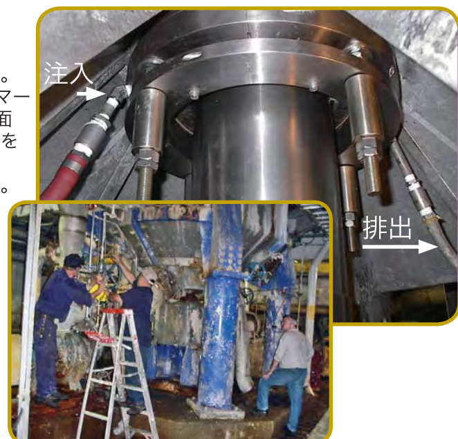
ボトムエントリーの300 mmハイコンパルパーに取り付けられた分割型EP TYPE-1シール
