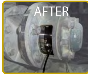
図3 乾燥硫黄粉末を処理するスクリューフィーダーの3" (76 mm)シャフトに取り付けられたMECO AH TYPE-2Sシール
