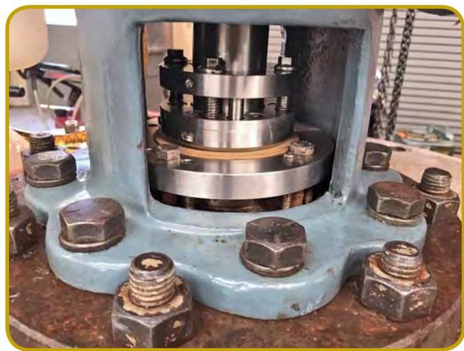
揮発性有機化合物および熔融プラスチック樹脂を処理する トップエントリーの攪拌機に取り付けられた2"OFS TYPE-1シール
