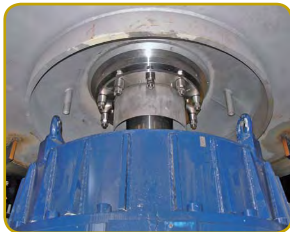
リサイクル紙を処理するパルパーに付いた 415 mmシャフトの分割型EP TYPE-1
