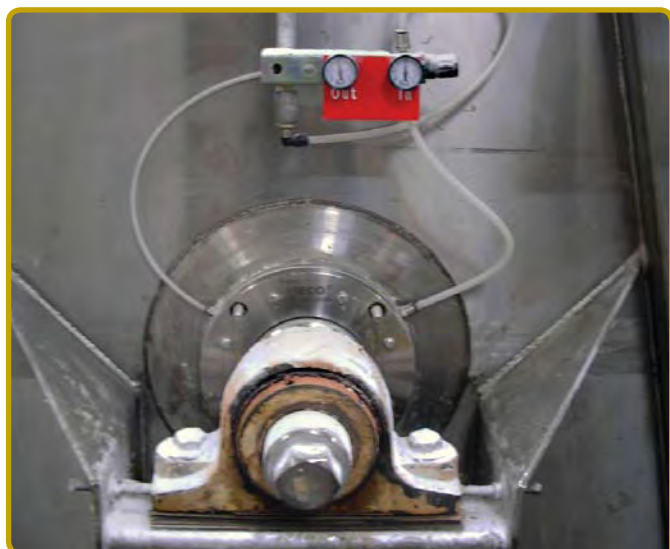
化学物質ブレンダーの6.5" (165 mm)シャフトに取り付けたAH TYPE-2 APシール
