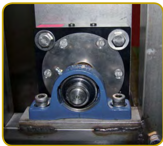
精糖機の30 mmシャフトに取り付けた HCZ1W4A119シール
