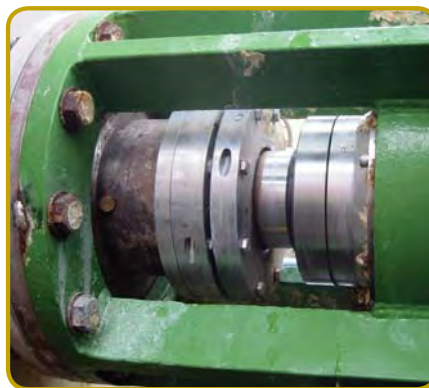
AFTER: 4"の紙料攪拌機に取り付けられた EA TYPE-1シール
