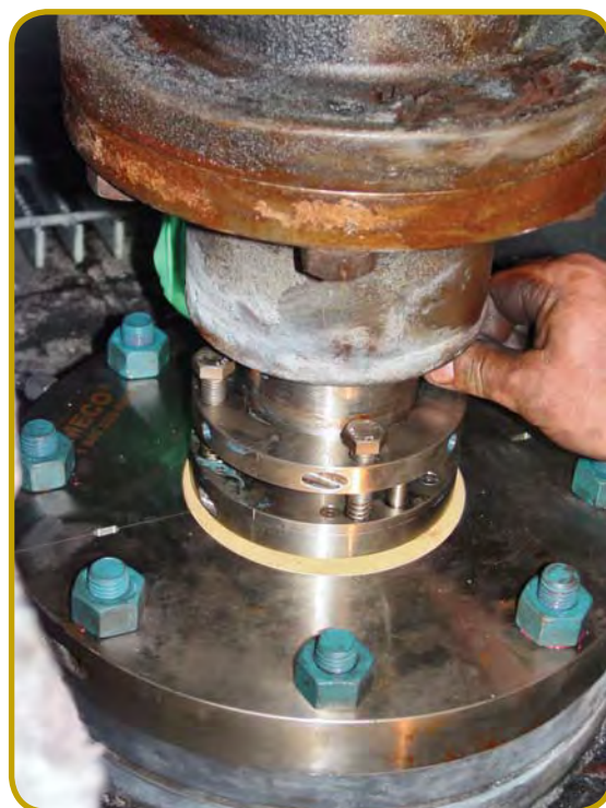
揮発性有機化合物 (VOCS) を含んだトップエントリーの攪拌機に取り付けた3.5"OFS TYPE-1シール
