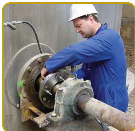
黒液攪拌機への4.5”の完全分割型EA TYPE-1シールの取り付け
