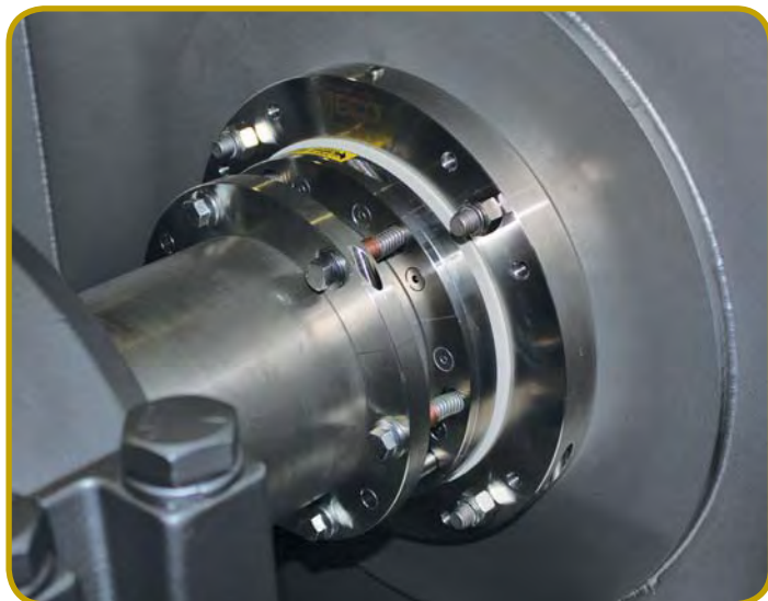
さまざまなグレードのプラスチック樹脂を処理するホリゾンタル ブレンダーに取り付けられた7"OFS TYPE-1シール
