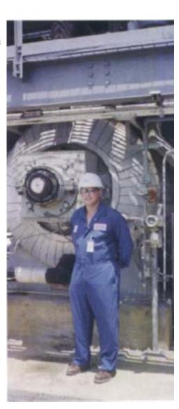
DuPont社設備管理エンジニアの クリス マーシャル氏はMECO カスタム シールの採用によって 同社の真空乾燥機の生産効率 を向上させることに成功した。 このシール摺動面は両側に広く形 成されるので、シャフトが偏芯し ていたり、熱膨張によって振れが 出た場合でも、標準的な仕様で、 1/4"(6.5mm)の遊びを許容する 事が出来る。 Dupont社のケース では、シールには窒素ガスのパー ジがかけられ、これがシール摺動 面の接圧を保持すると共に、漕内 からシール内に粉体が漏れ出すの を防ぐ役目をしている。
